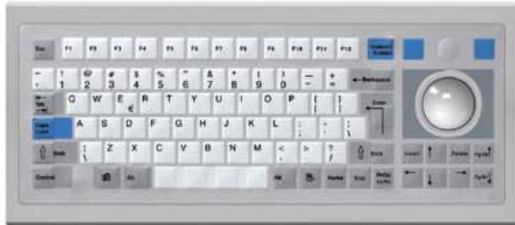
Tastiera a membrana, tasto a corsa breve, con cupola metallica su circuito stampato, frontale in poliestere, incassata all'interno di una cornice in alluminio ossidato.
