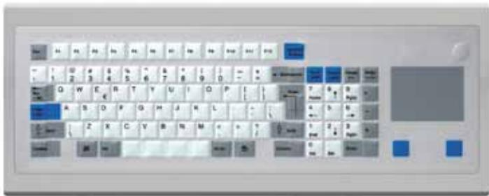
Tastiera a membrana, tasto a corsa breve, con cupola metallica su circuito stampato, frontale in poliestere, incassata all'interno di una cornice in alluminio ossidato.
