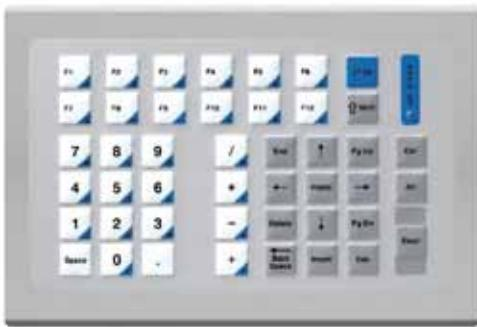
Tastiera a membrana, tasto a corsa breve, con cupola metallica su circuito stampato, frontale in poliestere, incassata all'interno di una cornice in alluminio ossidato.
