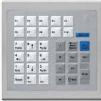
Tastiera a membrana, tasto a corsa breve, con cupola metallica su circuito stampato, frontale in poliestere, incassata all'interno di una cornice in alluminio ossidato.
