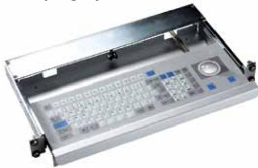
Tastiera a membrana, tasto a corsa breve, con cupola metallica su circuito stampato, frontale in poliestere, montata su cassetto estraibile, compatibile con rack 19" altezza 1 unità.
