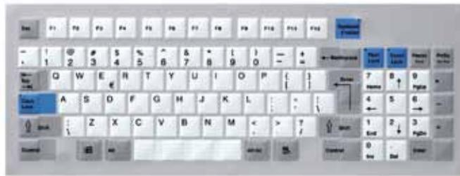
Tastiera a membrana, tasto a corsa breve, con cupola metallica su circuito stampato, frontale in poliestere, incassata all'interno di una cornice in alluminio ossidato.
